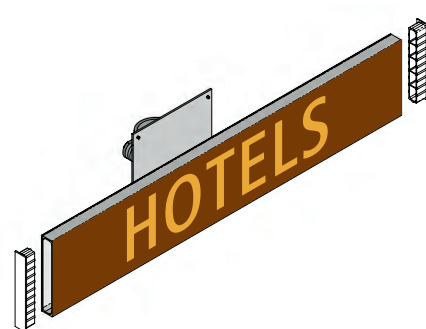
Zentrale Montage mit Briden (bitte Rohr Ø angeben)
