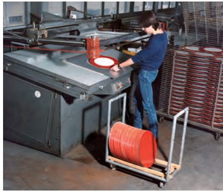
Siebdruckhalbautomat zum Bedrucken von Strassensignalen.
