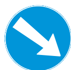
2.34 Hindernis rechts umfahren
