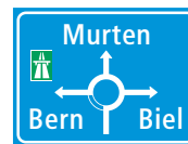
4.54 Vorwegweiser bei Kreisverkehrsplatz
